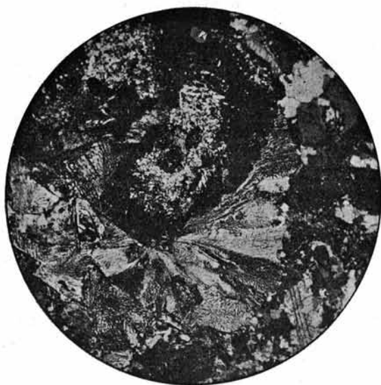
Fig. 4. — Microgranulite à étoilement de La Bastide-l'Évêque Grossissement 55 diam.
