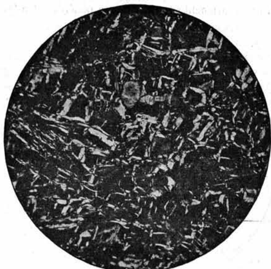
Fig. 3. — Serpentine de Najac à structure en partie maillée, en partie fenestrée. — Grossissement 55 diam.
