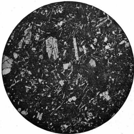
Fig. 8. — Porphyrite à pyroxène de Planioles. Grossissement 55 diam.
