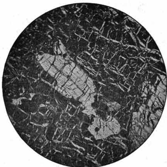
Fig. 1. — Serpentine du Puy de Voll à structure fenestrée montrant un cristal d'amphibole. Grossissement 35 diam.
