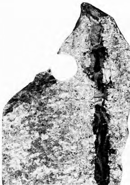
FIG. 14 — Filonnet (2 cm de puissance) de quartz à wolframite encaissé dans l'orthogneiss; remarquer la zone silicifiée qui renferme de la scheelite (le trou circulaire a été réalisé pour prélever une plage de scheelite).
