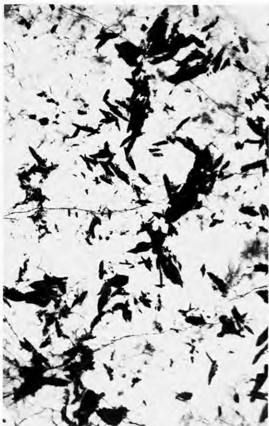
FIG. 13 — Fragment d'un filon de quartz, scié dans le sens du filon, montrant des cristaux de wolframite de 2 à 10 cm de long.
