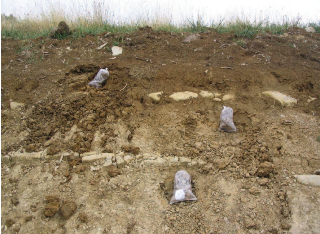
Fig. 8 - Détail montrant le Membre des Marnes et Calcaires à Hildoceras avec l'alternance de lits marneux épais (sacs à prélèvements) et de bancs carbonatés noduleux discontinus.
