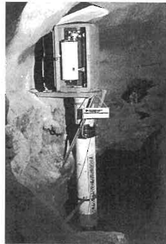
Photographie 13 : Limnigraphe du ruisseau souterrain de Cabéou équipé en 1976. Cliché Claude Bou.
