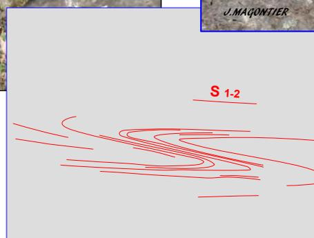
Ces plis, synfoliaux (Fig. 17 B & C), sont caractéristiques des déformations précoces, hercyniennes. Sur le même affleurement (Fig. 17 C), ces objets tectoniques précoces sont repris par un plis métrique, d'axe proche de la direction N-S, tardif (figure de superposition de plis = critère chronologique).
