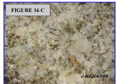
L'observation d'un échantillon à la loupe révèle parfois la présence d'une texture micrographique : quartz et feldspath alcalin s'interpénètrent (> aspect d'écriture cunéiforme) et ont donc cristallisé ensemble.
